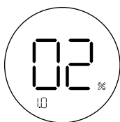
Рис. 20. Настройка отопительной кривой.
